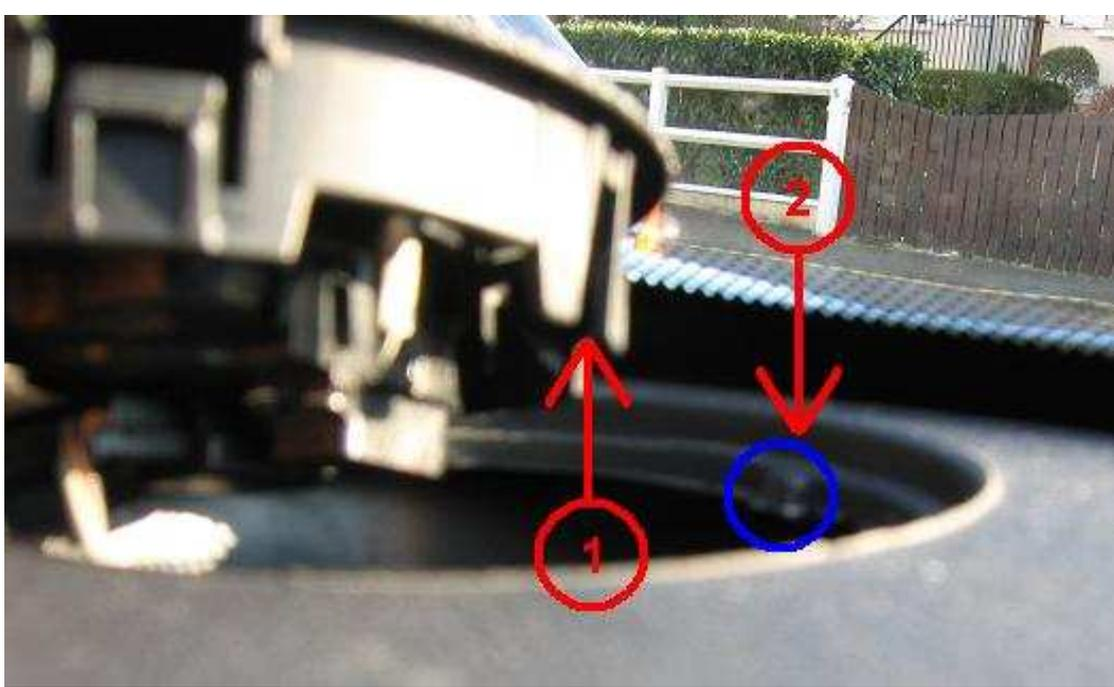
Enfoncer la grille à fond (elle doit être alignée avec le tableau de bord)
